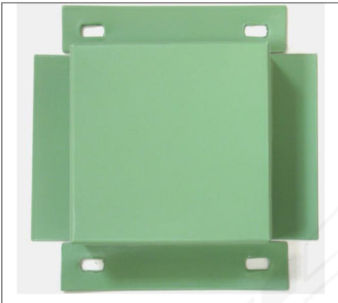
Рис. 1 – Внешний вид исследуемой металлокассеты № 1 в состоянии поставки.
